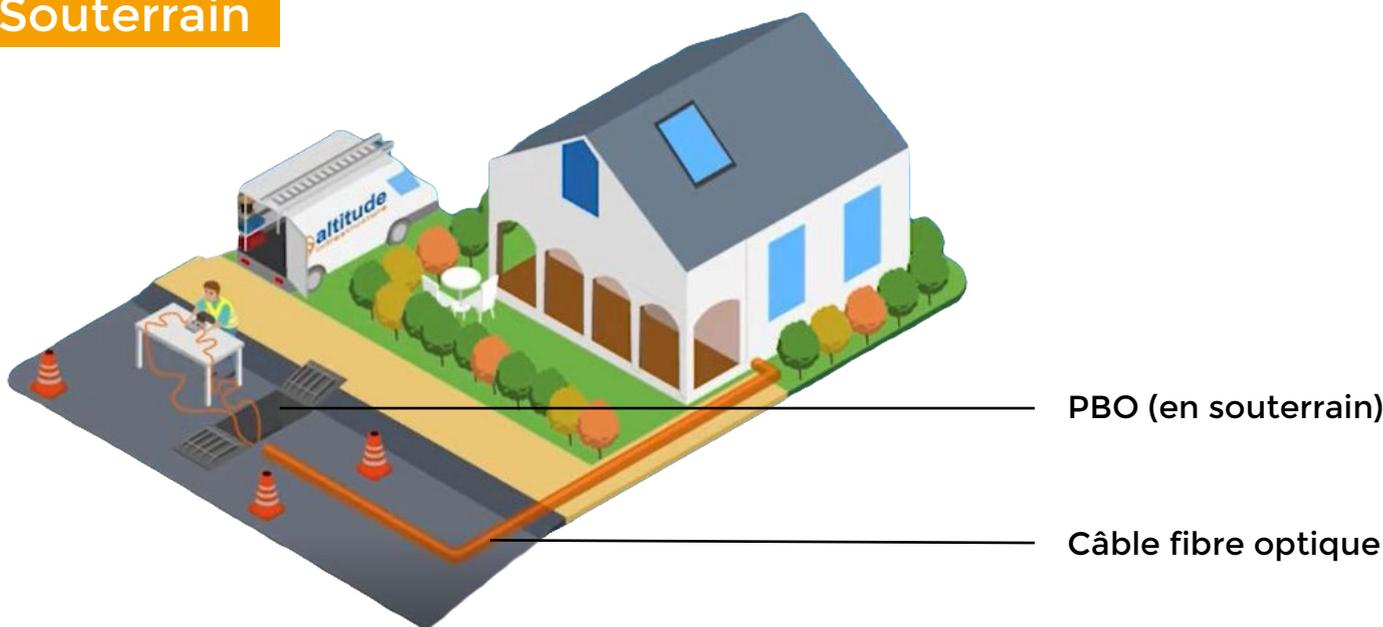
Pour réaliser le raccordement d'un domicile, des techniciens mandatés par l'opérateur du réseau procèdent au tirage d'un câble optique en fonction de la configuration du **PBO situé sur la voie publique (aérien, souterrain ou en façade)** et de la pénétration du logement.
